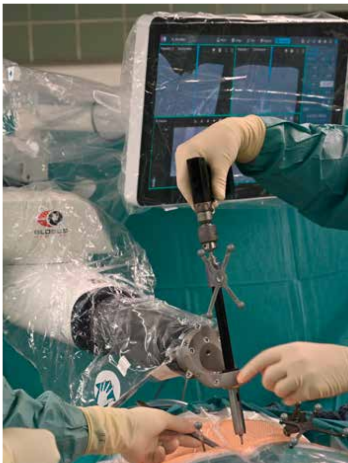
Geführtes Bohren eines Schraubenkanals durch den Endeffektor am Arm des Roboters. Der Monitor im Hintergrund liefert dreidimensionale Echtzeitdaten.
